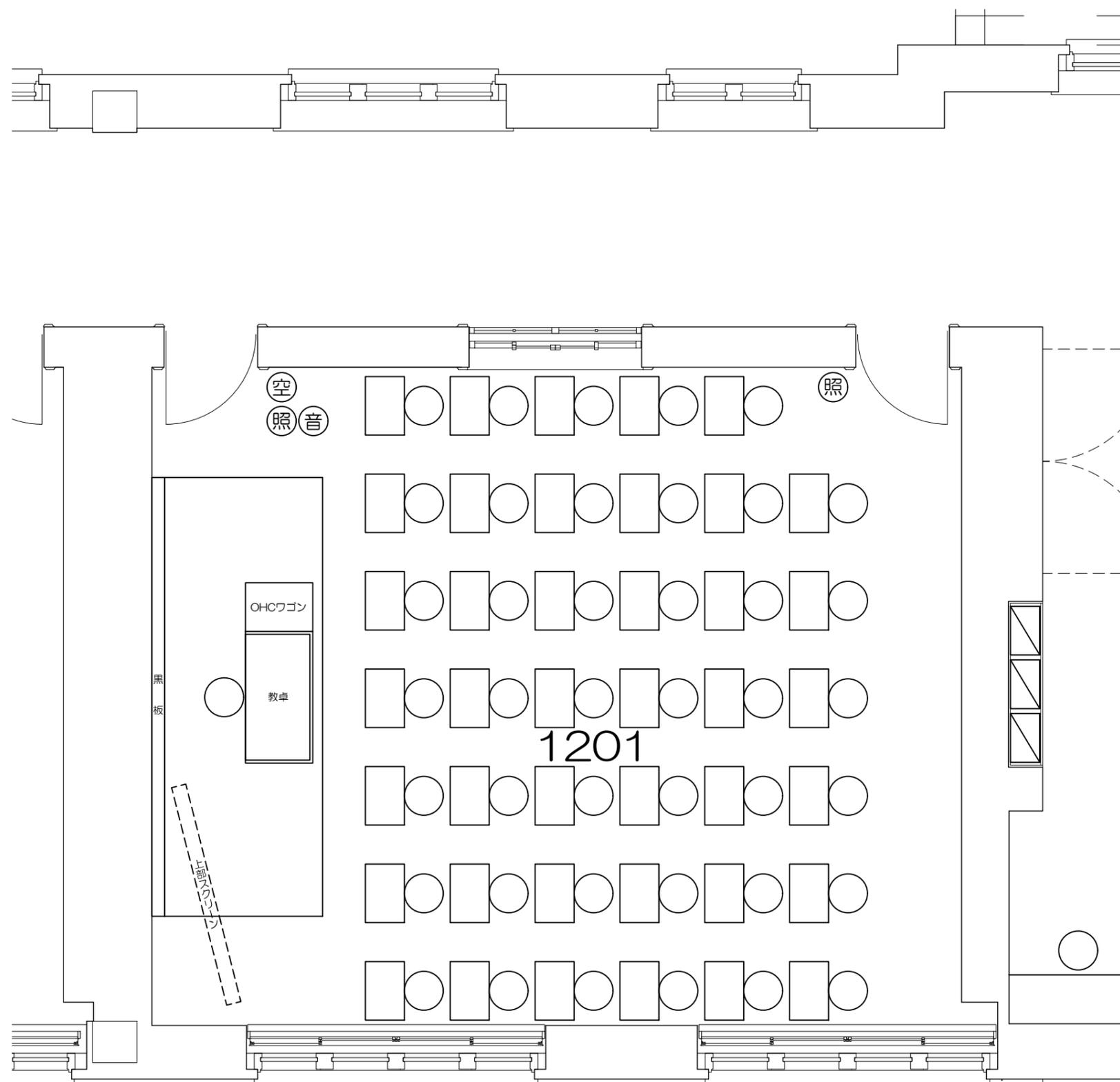
凡例 (照) : 照明スイッチ (空) : 空調スイッチ (音) : 音量スイッチ
