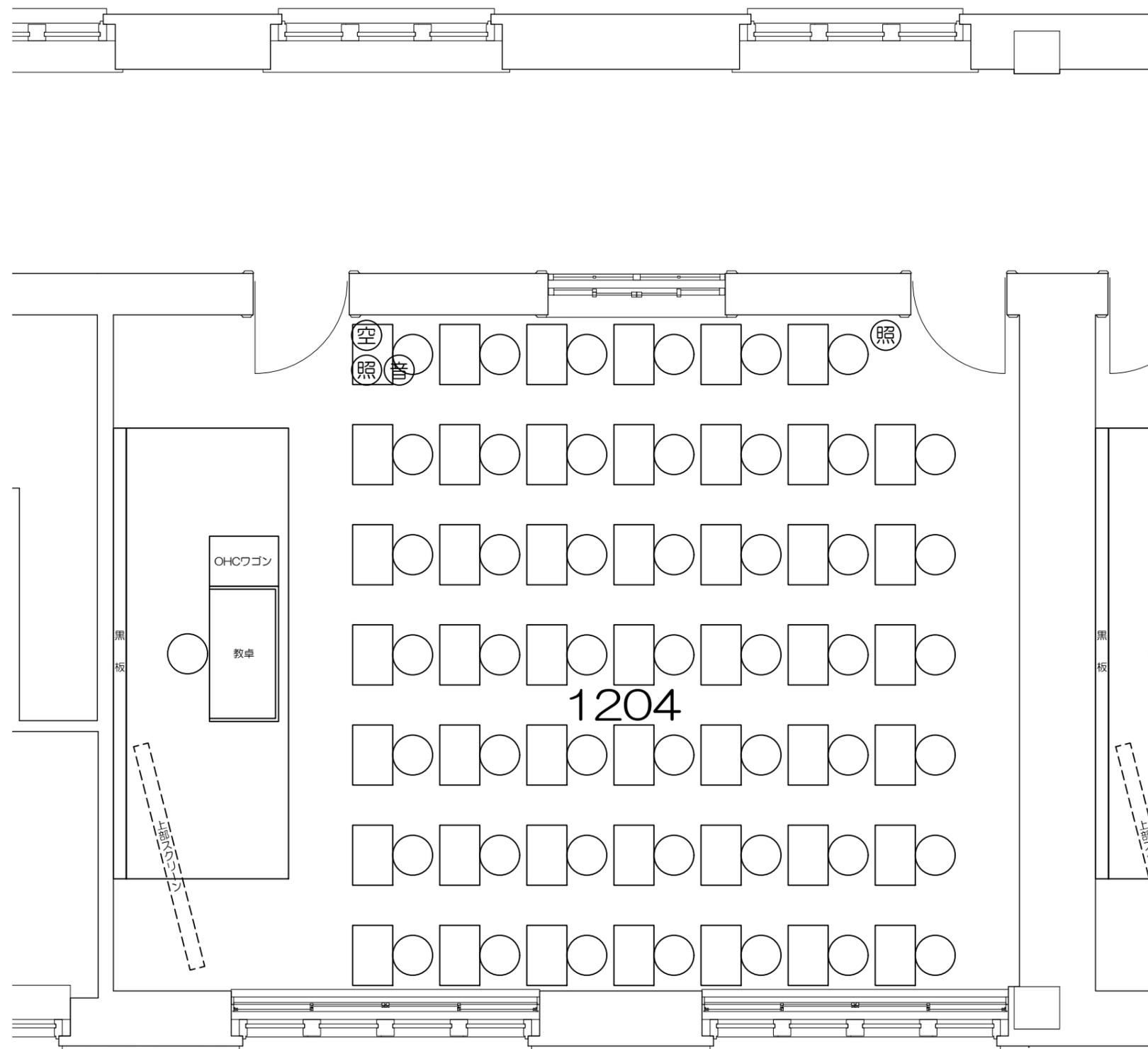
凡例 (照) : 照明スイッチ (空) : 空調スイッチ (音) : 音量スイッチ
