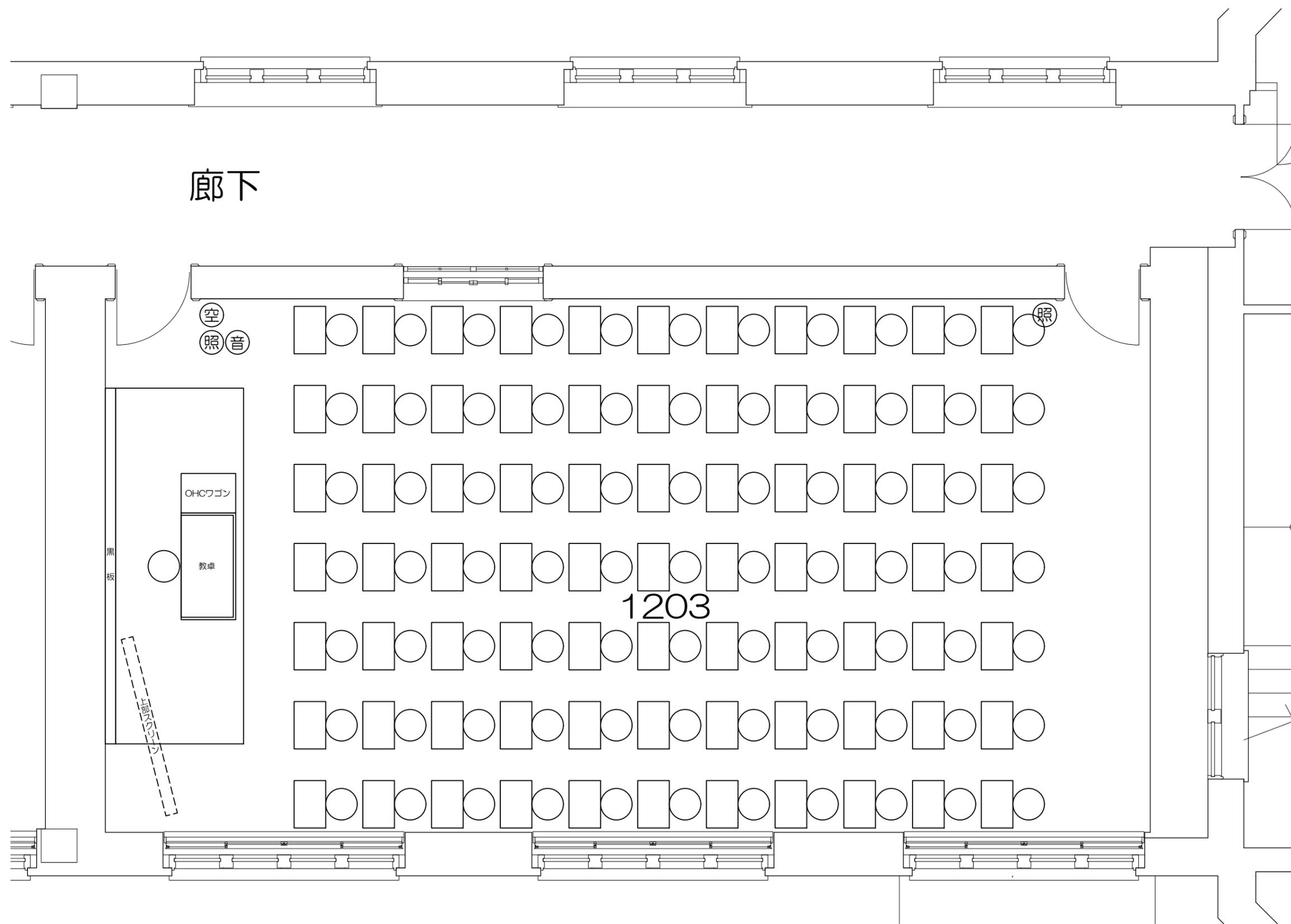
凡例 (照) : 照明スイッチ (空) : 空調スイッチ (音) : 音量スイッチ
